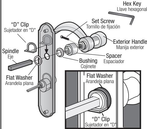
Ensamble la manija exterior y el cojinete a través de la placa de ajuste exterior. Desde la parte posterior de la placa de ajuste, coloque la arandela plana en el poste de la manija y deslice el sujetador en "D" sobre la arandela. Cercórese de que el sujetador en "D" esté colocado con la abertura hacia abajo como se ilustra y luego inserte el eje en la manija. Apriete el tornillo de fijación con la llave hexagonal (Allen) que se suministra.
