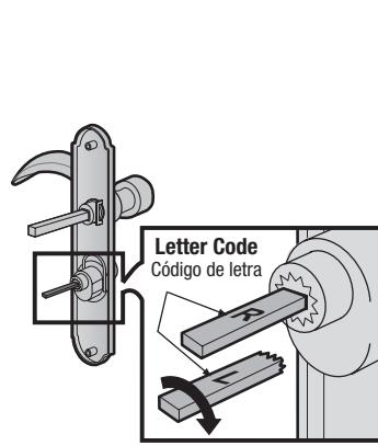
Inserte la llave y rote el eje del pestillo de doble seguridad de modo que el código de la letra adecuada esté orientado hacia arriba.
