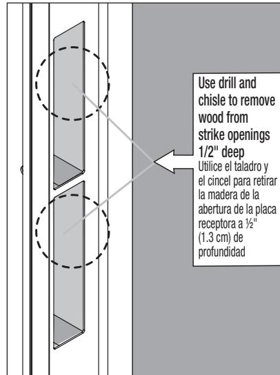
**IMPORTANTE:** compruebe que dispone de espacio detrás del marco de montaje del lado del pestillo para que funcione adecuadamente la cerradura de doble seguridad. Utilice el taladro y el cincel para retirar la madera de la abertura de la placa receptora a  $\frac{1}{2}$ " (1.3 cm) de profundidad
